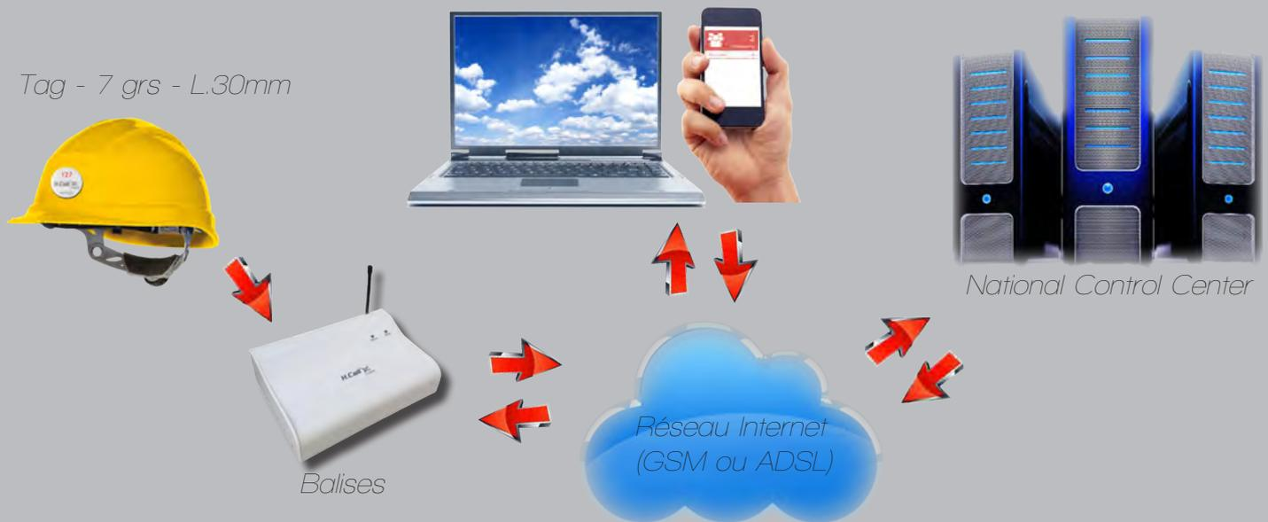
**Option : Système 100% Autonome : « Modem GSM et Batteries 12 volts » dans le cas de chantiers isolés.**
